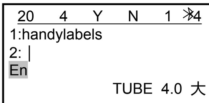
再次按【中英】键，切换至“中文”输入状态——输入拼音（最多可输入3个候选字拼音）——按下空格进行候选字转化——按【▶】选取所需文字，按空格确认。
