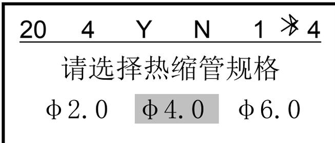
按照您已安装的耗材规格用【◀】、【▶】做出正确选择。按【Enter】，进入文档输入界面，即可进行内容编辑。
