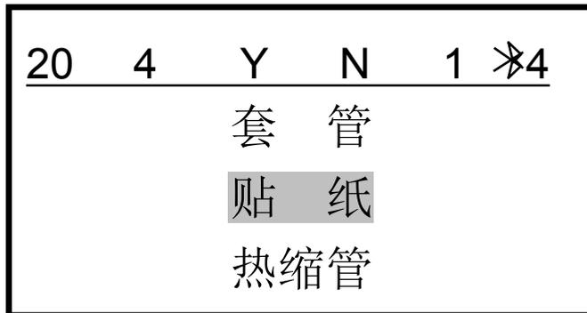
按【▲】、【▼】键，选择您要打印的耗材，按【Enter】，选择套管、贴纸、热缩管，选择界面，屏幕将显示以下界面：
